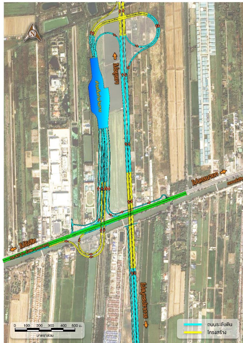
รูปที่ 5-1 รูปแบบทางแยกต่างระดับบริเวณจุดตัดทางหลวงหมายเลข 305 (ถนนรังสิต - นครนายก)
